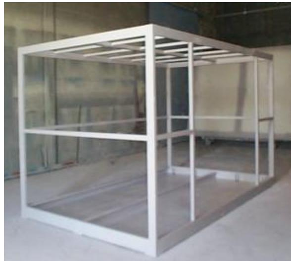
*Les soudures sont entièrement meulées, les assemblages siliconés,*
